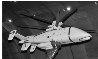
图3 NASA AMES 40 ft×80 ft S97模型风洞试验
