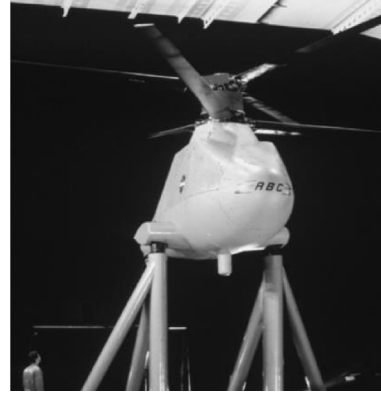
图1 NASA 40 ft×80 ft风洞前行桨叶概念旋翼模型试验
