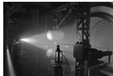
图 10 \phi 2\text{ m} 共轴刚性旋翼 PIV 试验
