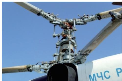
图 4 典型共轴双旋翼桨毂外形
