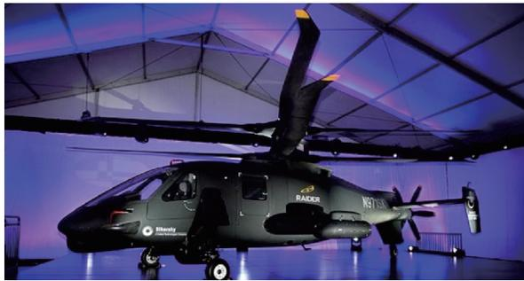
图 16 美国共轴刚性旋翼气动布局设计方案<sup>[21]</sup>
