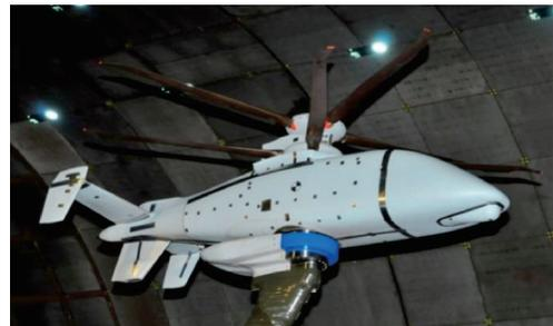
图22 S-97缩比模型风洞试验<sup>[21]</sup>
