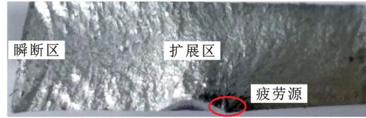
图2 2A12铝合金试验件疲劳断口
