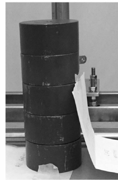
图 11 5# 波形弹簧 200 N 耐压试验
