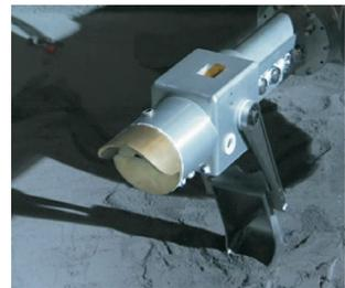
图 16 模拟月壤铲挖实物图
