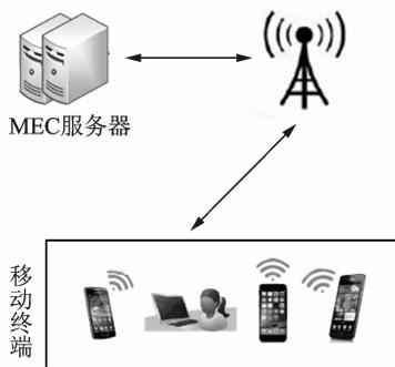
图 1 Cloudlet 与 MEC 网络架构
