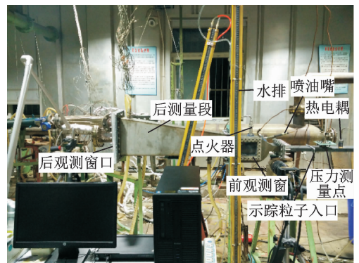
图2 PIV试验系统实物图
