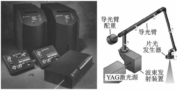
图 4 PIV 系统的激光器(左)及光臂(右)
