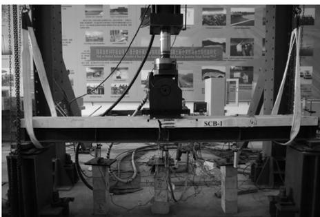
图3 试验梁加载过程
