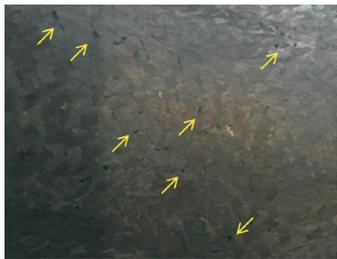
图8 缺陷区域打磨后表面状态(箭头所指为缺陷)
