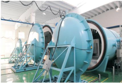
图3 直升机蒸发循环制冷系统试验台
