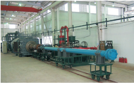
图3 \varnothing 0.6 m 脉冲燃烧风洞
