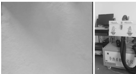
图 7 测试用纤维板与平板导热系数测量仪
