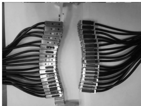
图12 根据检测方案设计的换能器楔块阵列
