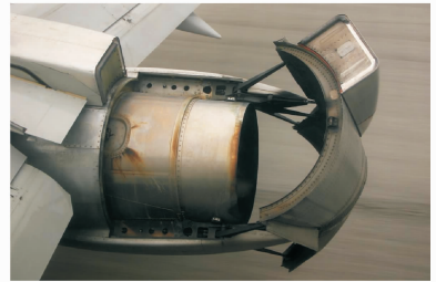
图 12 靶式反推力装置
