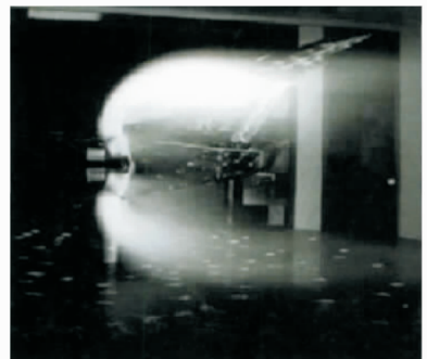
图 13 民用涡扇发动机反推热流重吸入试验 [55]
