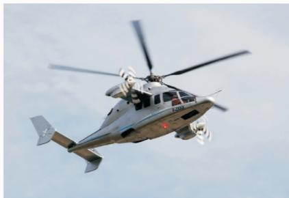
图 1 X3 构型复合式高速直升机
