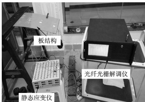
图 4 单边固支板结构应变监测系统
