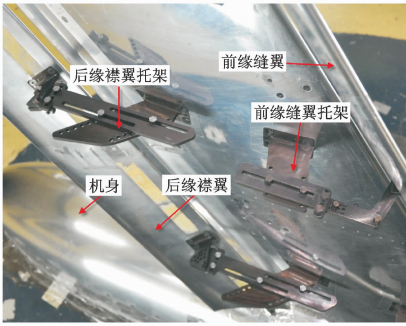
图2 模型增升装置安装示意图 Fig. 2 Set-up of high-lift configuration
