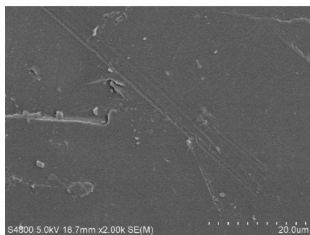
图 2 添加 1% Fe 3 O 4 环氧体系胶液固化后冲击断口的扫描电镜照片
