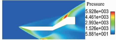
图 16 二维扩张管道高超声速绕流压力云图
