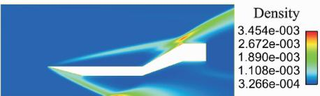
图 14 二维扩张管道高超声速绕流密度云图
