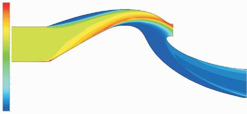
图3 粒子分离器流道液态水含量
