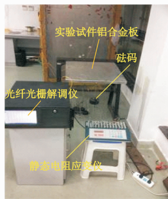
图 7 板结构应变监测系统
