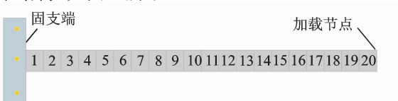
图 3 单边固支梁结构
