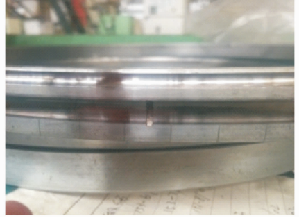
图10 内圈故障(试验件4):槽宽1.5 mm,槽深0.4 mm
