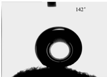
图 5 棉毡接触角测试图
