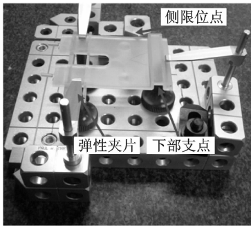
图2 复杂几何体 CMM 实验夹持装置
