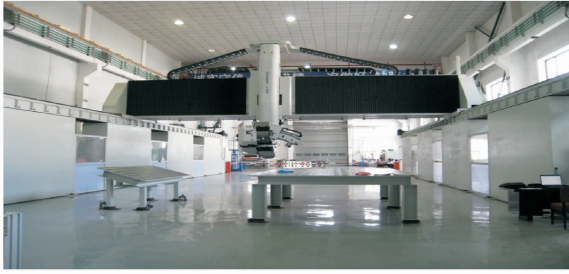
图 8 大型龙门铺带机系统
