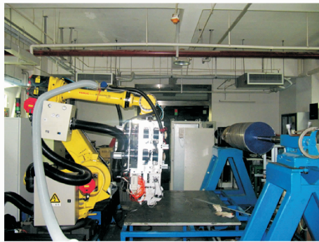
图 14 16 丝束铺丝机器人 Fig. 14 Fiber placement robot with 16 tows
