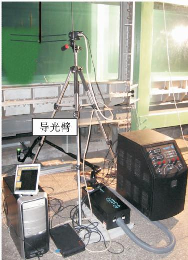
图4 旋翼试验架和PIV布置
