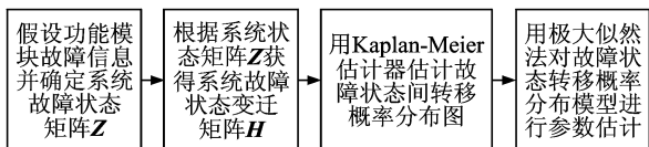
图 10 故障状态间转移概率分布模型确定流程图
