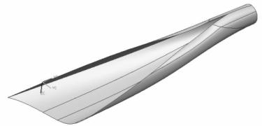
图3 类水滴进口高超内收缩进气道气动构型(不含隔离段)
