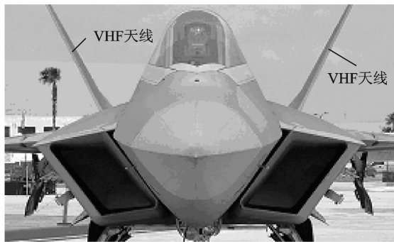
图 7 VHF 天线倾斜安装于 V 尾中的示意图
