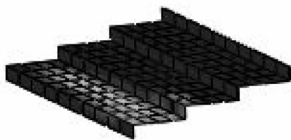
图 4 d=1.6 mm 时胶接界面破坏模式
