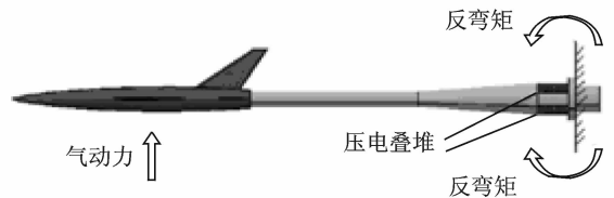
图2 安装有压电陶瓷叠堆的模型支撑结构
