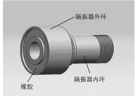
图 4 APU 橡胶隔振器结构示意图
