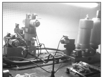
图4 实验液压系统阀门布置
