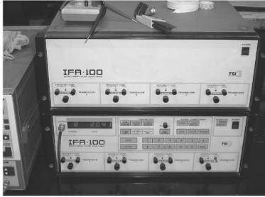
图3 热线风速仪
