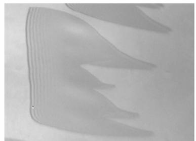
图8 层流状态下的干涉条纹
