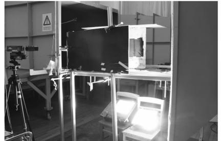
图7 油膜干涉测量法光路布置
