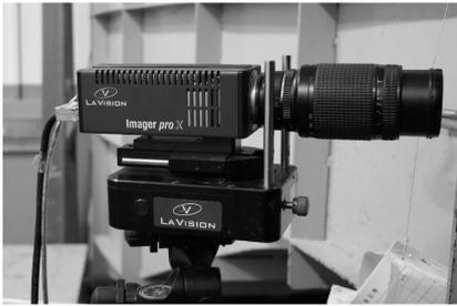
图4 CCD相机和镜头
