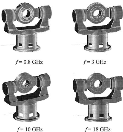
图4 垂直极化下( $\alpha=0^\circ, \beta=0^\circ$ )不同频率下的表面感应电流分布图
