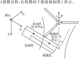
旋翼对机翼的尾流干扰
