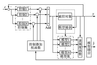
图 10 多模型控制系统结构
