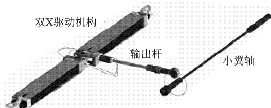
图11 驱动机构驱动小翼示意图
