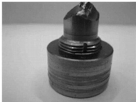
图8 底孔直径过小引起丝锥断裂照片
