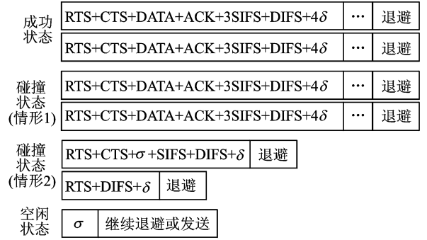
图 2 节点在不同信道状态下的时序图
