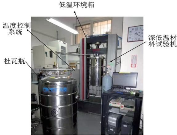
图 3 深低温力学测试系统组成示意图
