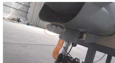
图1 激光相对引导系统合作目标安装位置示意图
