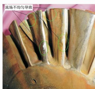
图 11 原阴极加工叶轮实体表面
