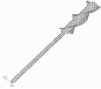
图 3 螺旋线刃阴极网格
