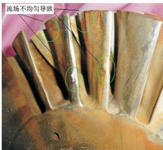
图11 原阴极加工叶轮实体表面
