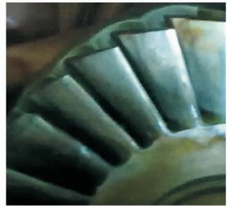
图12 新阴极加工叶轮实体表面
