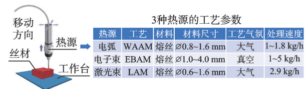
图 1 金属熔丝增材制造技术原理与主要工艺参数
