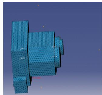
图 10 齿轮箱声学边界元模型
