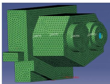
图 7 齿轮箱有限元模型
