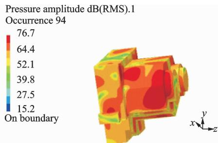
图 11 1782 Hz 箱体表面声压云图
