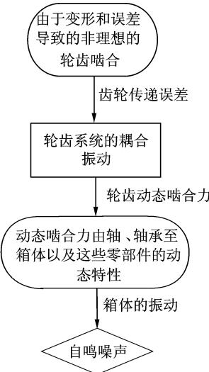
图2 齿轮系统振动噪声产生机理
