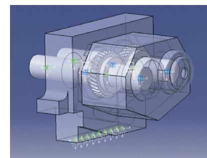
图 5 齿轮箱系统多体动力学模型
