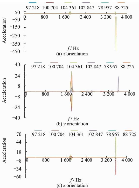
图 8 齿轮箱表面节点在 3 个方向上的振动加速度曲线
