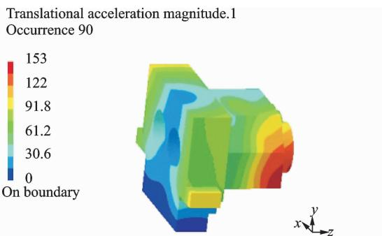
图 9 1782 Hz 振动加速度云图
